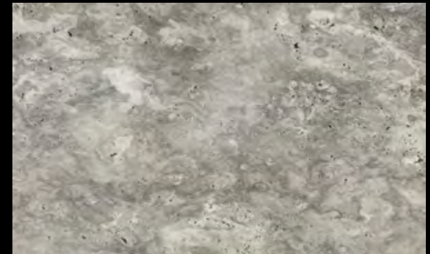
TRAVERTINO ETRUSCO - PŘÍČNÝ ŘEZ
